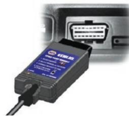
Conecte la herramienta al puerto de OBDII
