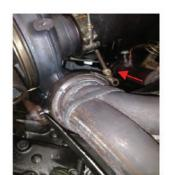
Retirer la bride de serrage Marman de l'orifice d'entrée de la Desinstale la abrazadera de apriete de tornillo del tubo de
