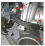
7. Remove and discard the fastener and the wire retainer Retirer et jeter la pièce de fixation et la bride de retenue Desinstale y deseche el sujetador y el retén del cable.
