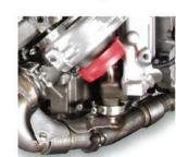
10. Loosen the exhaust inlet pipe-to-EGR cooler clamp. Desserrer le collier de serrage qui unit le tuyau d'entrée des gaz d'échappement au refroidisseur du système RGE. Afloje la abrazadera que conecta la tubería de entrada del
