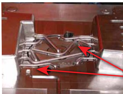
Conducteurs NAPA Echlin préparés pour le processus de moulage par injection
